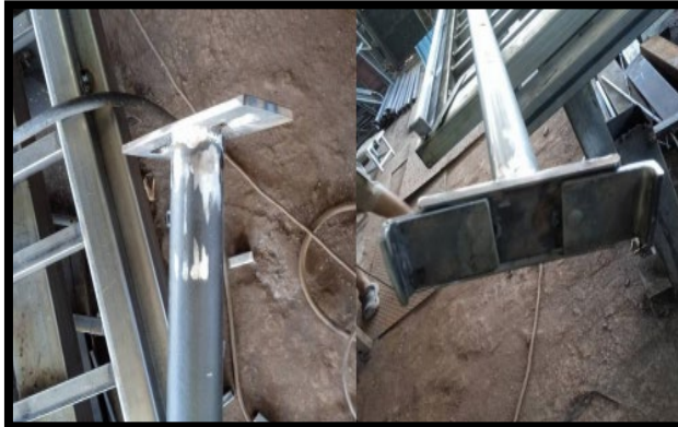
Rajah 7: Pemasangan Tapak Atas dan Pam Hidraulik Bagi Flexible Shoring
