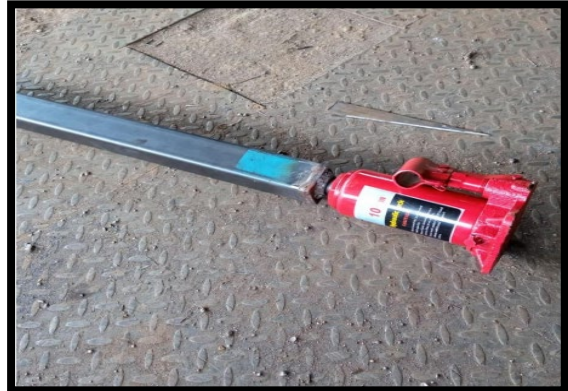
Rajah 7: Pemasangan Tapak Atas dan Pam Hidraulik Bagi Flexible Shoring
