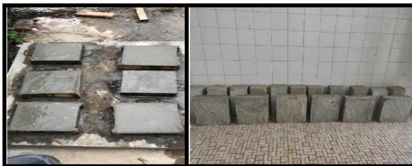
Rajah 3: Sampel Eco Paver Blocks yang dihasilkan
