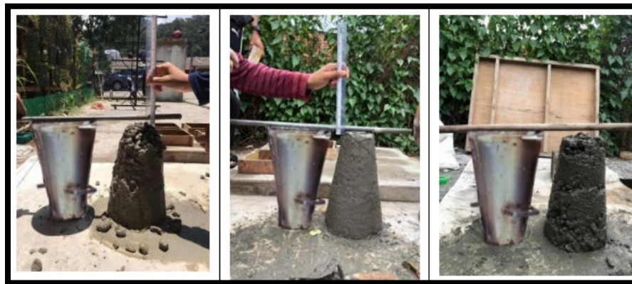
Rajah 4: Ujikaji Penurunan Konkrit Mengikut Nisbah Bancuhan 0%, 5% dan 10%
