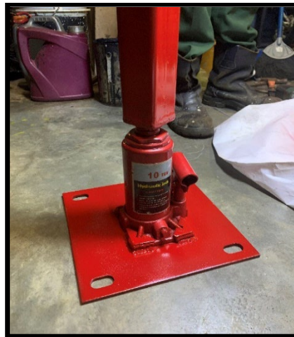
Rajah 8: Proses Pemasangan Tapak Pam Hidraulik
